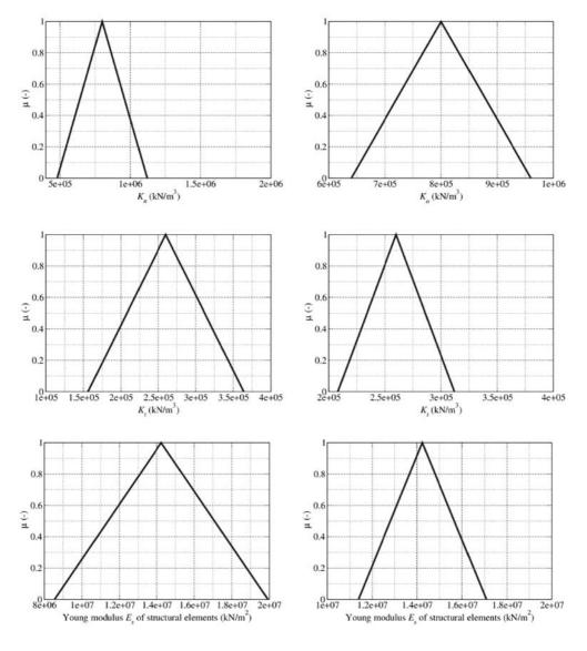
Fig. 5. Membership functions for  $K_n$ ,  $K_t$  and  $E_s$  for case 1 (left) and case 2 (right) Rys. 5. Funkcja przynależności dla  $K_n$ ,  $K_t$  i  $E_s$  dla przypadku 1 (po lewej) i przypadku 2 (po prawej)
