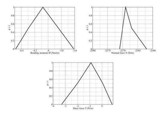
Fig. 7. Membership functions for bending moment, normal force and shear force (element 48) for case 2 Rys. 7. Funkcja przynależności dla momentu zginającego, siły normalnej i siły ścinającej w elemencie 48 dla przypadku 2
