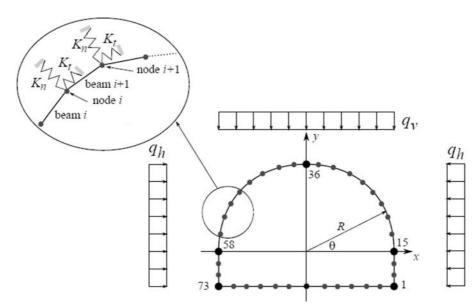
Fig. 1. Layout of the model, horizontal  $(q_h)$  and vertical loads  $(q_v)$  and node numbers (R = 5.75 m)Rys. 1. Szkic modelu – obciążenie poziome  $(q_h)$  i pionowe  $(q_v)$ , zaznaczono numery węzłów (promień R = 5,75 m)
